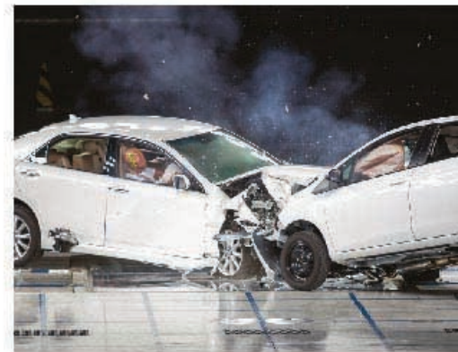
Figura 2.1 Los fabricantes de automóviles realizan pruebas de choque controladas. Estas pruebas consisten en estrellar vehículos contra muros de concreto, o bien, provocar choques entre vehículos de prueba. Las colisiones son estudiadas utilizando cámaras e instrumentos de medición capaces de registrar diferentes magnitudes, como la distancia y el tiempo transcurrido.
