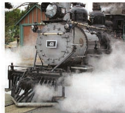
Figura 14.1 Las locomotoras de vapor fueron algunas de las primeras máquinas térmicas que se construyeron, lo cual fue posible gracias a los diseños desarrollados por el ingeniero escocés James Watt.
