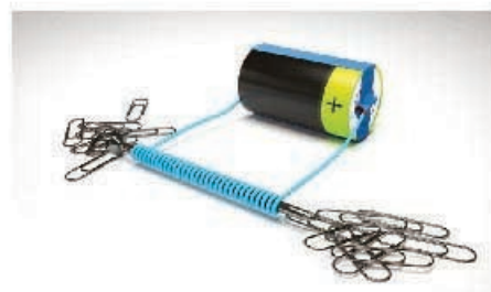
Figura 7.8 Electroimán. El clavo se comporta como imán mientras la corriente eléctrica circula a través de las espirales de alambre que lo rodean.
