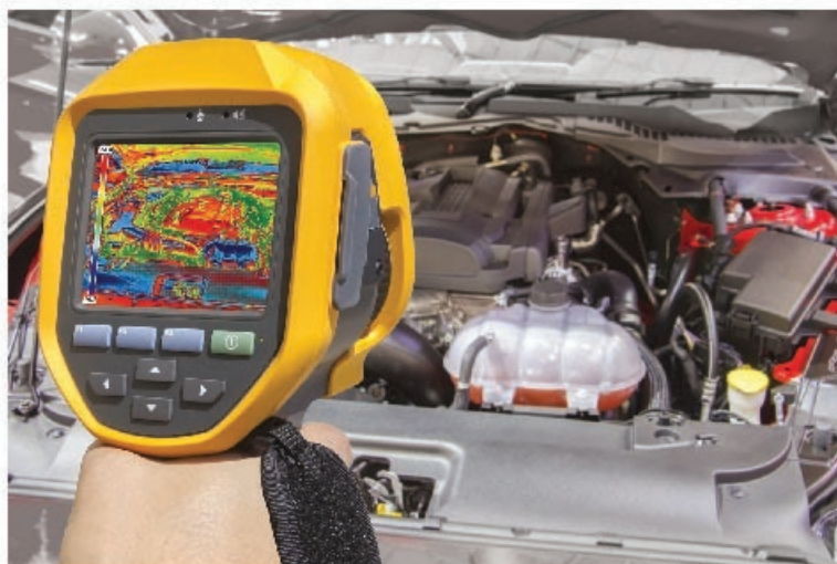
Figura 10.7 Mediante una cámara térmica un mecánico automotriz puede conocer la temperatura del motor de un vehículo antes de intervenir en una avería.
