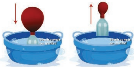
Figura 9.6 Cuando la botella se introduce en el agua, el globo se infla un poco. Cuando la botella se saca del agua, el globo vuelve a su estado original.
