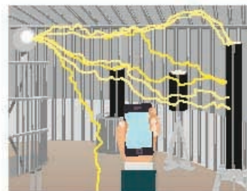
Figura 7.4 La jaula de Faraday es ideal para evitar llamadas con teléfonos celulares, pues anula el efecto de los campos magnéticos.
