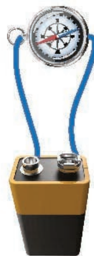
Figura 7.5 Coloca el cable detrás de la brújula en la misma dirección Norte-Sur a la que apunta la aguja.
