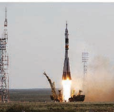
Figura 20.10 Uno de los ejemplos más impresionantes del efecto de la fuerza de reacción son los cohetes espaciales. El chorro de gases dirigido hacia abajo (fuerza de acción) empuja verticalmente hacia arriba la nave (fuerza de reacción).
