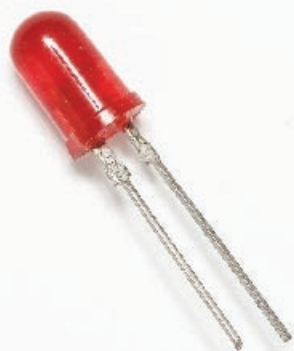
Figura 5.2 LED son las siglas de la expresión de la lengua inglesa light-emitting diode , "diodo emisor de luz", que es un tipo de foco empleado en computadoras, controles remotos o paneles de control.
