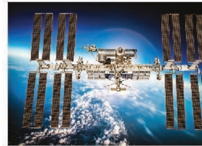
Figura 16.10 Los paneles rectangulares en los extremos de la Estación Espacial Internacional proveen de energía al satélite.
